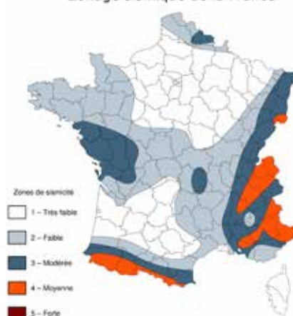
Zonage sismique de la France
